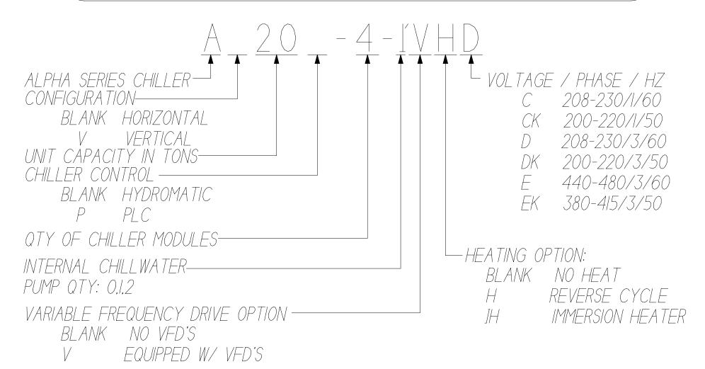
EXAMPLE: A20-4-IVHD 20 TON. HORIZONTAL RACK. 4 STAGE. I CHILLWATER PUMP. VARIABLE FREQUENCY DRIVES. REVERSE CYCLE HEATING. 208-230/3/60 POWER INPUT.
